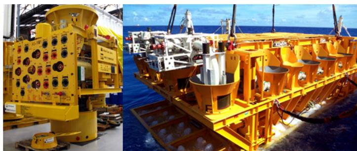
Figura 5 – Árvore de Natal molhada (esquerda) e *manifolds* (direita). (PETROBRAS1, 2015).
